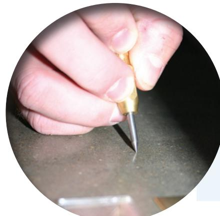
**Slika 4- test tvrdoće poda:** Na slici je testiranje tvrdoće olovkom poliranog betona prema Mohs skali.
