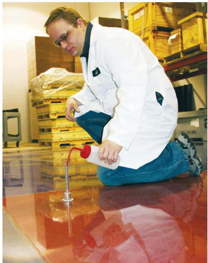
**Slika 3 -Rilem cev:** Smart floor profesionalci su trenirani da upotrebljavaju pribor za testiranje. Na ovoj slici, tehničar upotrebljava Rilem cev da proveri otpornost poda na upijanje vode na dekorativnom C2 Smart floor podu.
